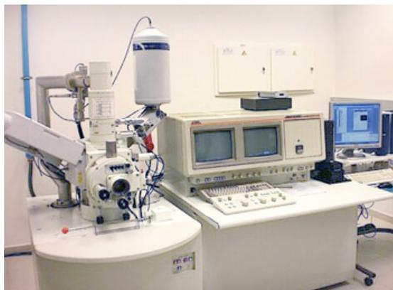
Para realizar el análisis se ha utilizado un voltaje de 20 KeV. Las muestras se han recubierto previamente con una capa nanométrica de grafito, con el fin de tratar la muestra para que sea conductora y que este recubrimiento no interfiera en el análisis.
