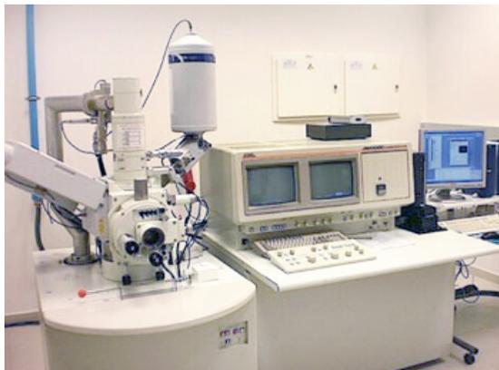
En cambio, si se utiliza un microscopio con detector de rayos X (EDX) además de obtener la imagen de la superficie de la muestra analizada, aunque a menor resolución, se puede obtener información analítica cualitativa y cuantitativa sobre la composición de determinados átomos.
